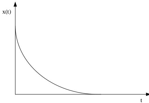
$$(c) \begin{cases} x_1 = x \\ x_2 = \dot{x} \end{cases} \Rightarrow \begin{bmatrix} \dot{x}_1 \\ \dot{x}_2 \end{bmatrix} = \begin{bmatrix} 0 & 1 \\ -2 & -3 \end{bmatrix} \begin{bmatrix} x_1 \\ x_2 \end{bmatrix}, y = x_1 \Leftrightarrow y = \begin{bmatrix} -2 & 0 \end{bmatrix} \begin{bmatrix} x_1 \\ x_2 \end{bmatrix}$$
