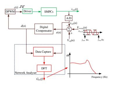
Fig. 14. Network Analyzer Scheme.
